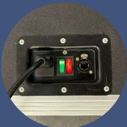
Cuvette en façade avec double interrupteur lumineux, alimentation et prise RJ45
